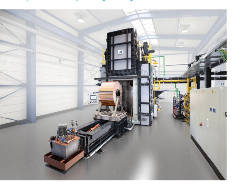
Neben unseren Wärmebehandlungsanlagen für das Presshärten und für die Wärmebehandlung von Aluminium, bieten wir in dem Bereich der Buntmetallindustrie Anlagen für die Wärmebehandlung von Bändern und Bunden aus **Kupfer sowie Kupferlegierungen** an.
