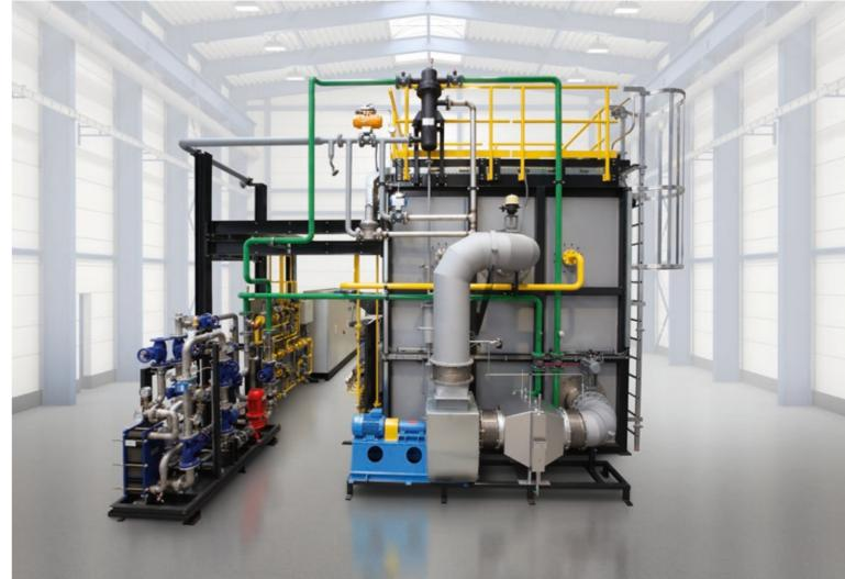
Der Glüh- und Kühlbetrieb erfolgt unter einem Stickstoff-Wasserstoff-Gemisch. Mit geringem Anteil von maximal 5 Prozent Wasserstoff werden Verweilzeiten erzielt, die in anderen Ofensystemen nur mit wesentlich höherem Wasserstoffanteil möglich sind. Dies trägt zur Reduzierung der Betriebskosten bei. Das Ofenkonzept kann als Ein-Coil oder Mehrfach-Coil-Anlage ausgeführt werden.
