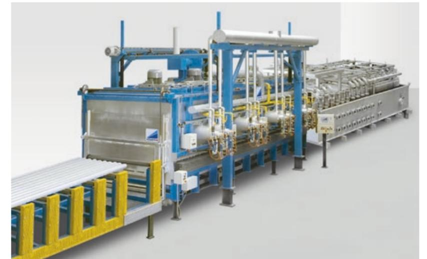
In unserem Rollenherdofen zum Lösungsglühen von Al-Stangen und -Profilen werden die Aluminiumteile, horizontal auf Abstand nebeneinanderliegend, über Rollen in die Heizkammer gefahren. Hier erhalten die Teile auf reversierbarem Rollentransport durch Hochkonvektion ihre Wärmebehandlung. Nach dem Glühvorgang wird das Gut umgehend in den anschließenden Hochdruck- und Niederdruck-Wasserquench gefahren und dann getrocknet.
