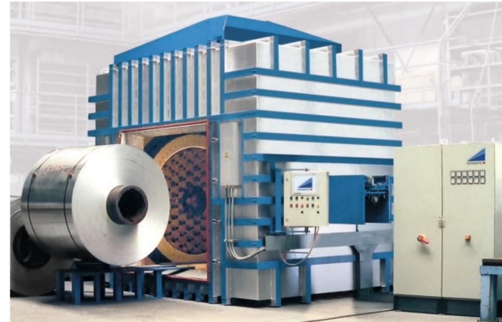
Das Jet Rotation Heating ist die Kombination aus Jet Heating und Rotation der Düsenfelder. Dieses patentierte System wurde von uns speziell zur perfekt gleichmäßigen Erwärmung von Aluminiumbunden entwickelt.
