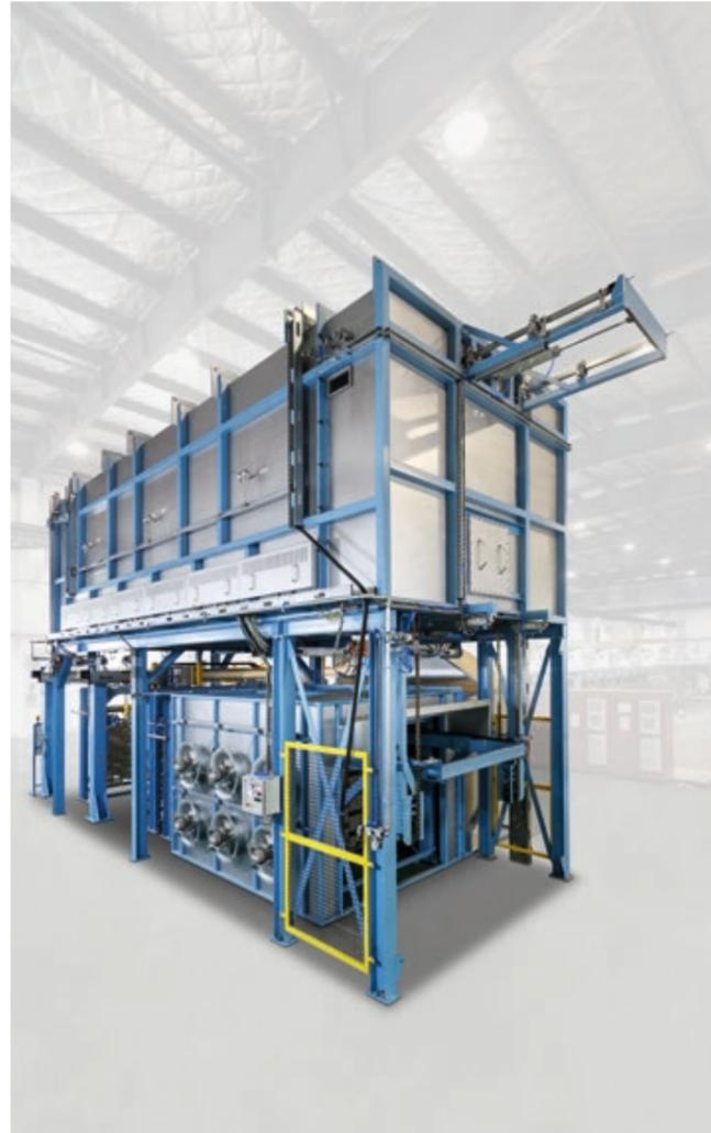
Im Durchstoßofen werden Teile in Gestelle eingelegt und mittels intensiver Luftumwälzung erwärmt. Hydraulische Stoßeinrichtungen befördern die Gestelle über Gleitbahnen im Takt durch den Heizraum. Die Einführung der beladenen Gestelle in den Ofen und ihre Entnahme am Ofenausgang erfolgen vertikal über elektromotorisch angetriebene Kettentransportsysteme. Für weitere Platzersparnis sorgt die Anordnung der Luftkühlzone unterhalb der Ofenanlage.
