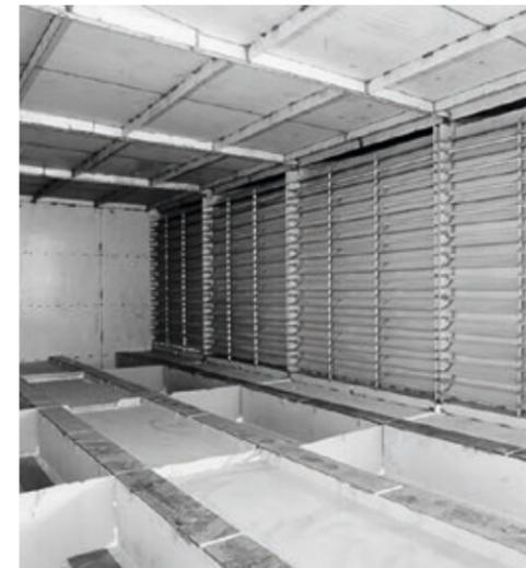
schwarz Kammeröfen dienen zur Erwärmung von Aluminiumbauteilen jeglicher Geometrie, wie z. B. Schüttgut in Transportbehältern, Barren, Bolzen oder auf Wagenträgern angeordneten Al-Bauteilen.
