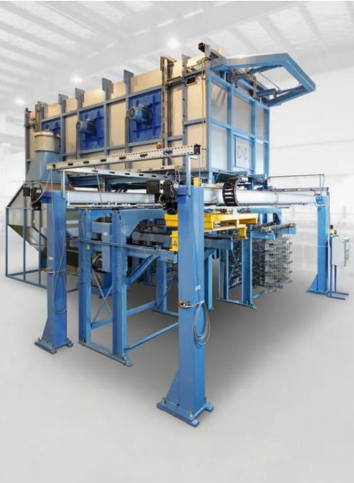
Neben Durchlauföfen fertigen wir zum Warmauslagern von Schmiedeteilen auch taktende Durchstoßöfen. Diese Anlagen bieten eine ebenfalls schnelle, gleichmäßige Erwärmung, die zügige Rückführung der Bauteile in den Betriebsablauf und – vor allem – einen deutlich reduzierten Platzbedarf.
