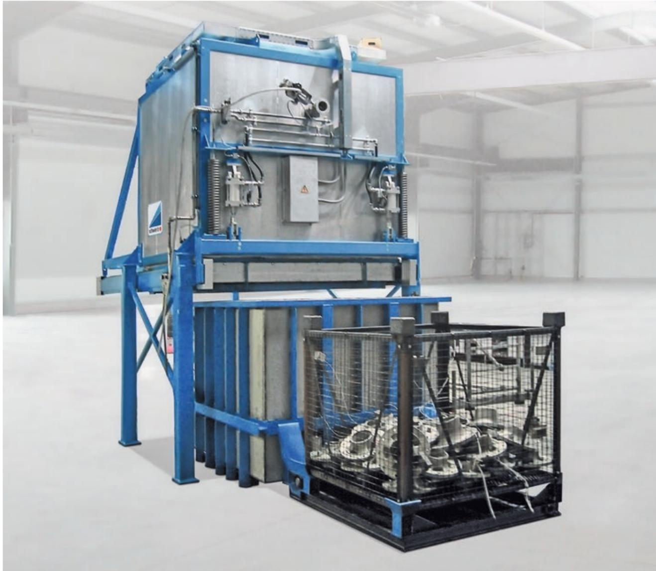
Eine raumsparende Alternative zum Kammerofen sind schwarz Elevatoröfen. Hierbei werden die Chargen mit den Al-Bauteilen, wie dünnwandige Bleche oder Gussteile, über eine integrierte Hebeeinrichtung von unten in den Ofen gehoben und darin arretiert.
