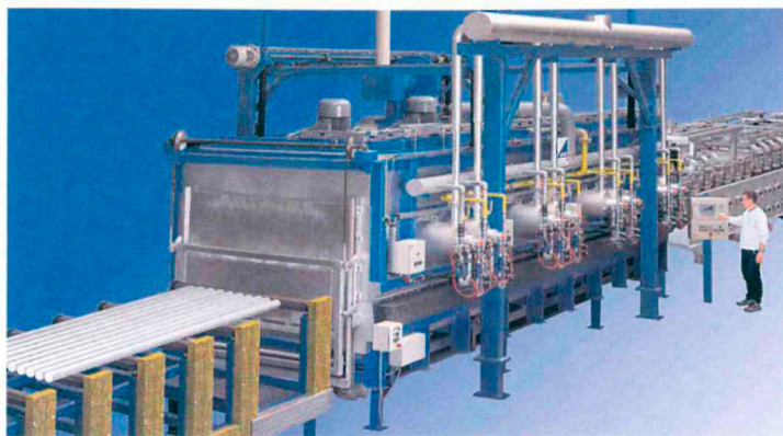
Abb. 5: Indirekt gasbeheizte Rollenherdofenanlage zum Lösungsglügen und Abschrecken von Aluminiumstangen und -profilen
