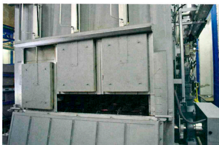
Abb. 4: Anlageneintragsseite mit Schiebern zur wahlweisen Entnahme, einzeln oder paarweise
