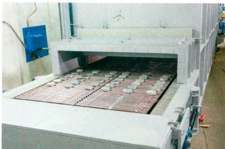
Abb. 3: Anlageneingang mit Aluminiumscheiben zur Messung der Materialtemperatur im Durchlauf
