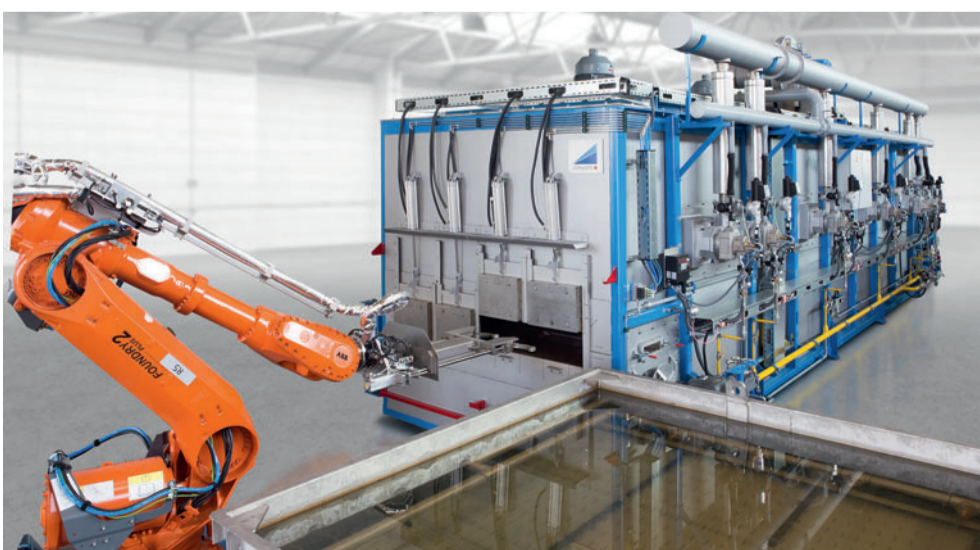
Die automatisierten schwarz-Linien haben kurze Taktzeiten von nur 5 bis 10 Sekunden
